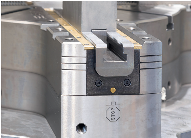
4 Prozesssichere Fertigung dank abgedichteter Backenführung: Die konsequente Abdichtung bewirkt weniger Fettaustrag in die Maschine – und somit weniger Fettverbrauch und weniger Verschmutzung des Kühlmittels © Schunk
