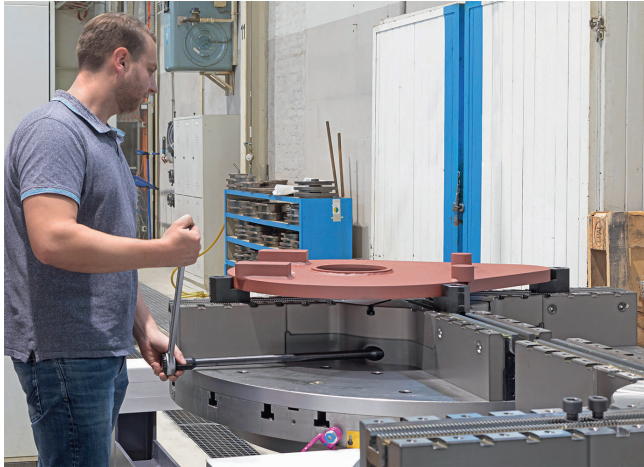
2 Aufspannen eines geometrisch ungleichmäßigen Flanschmoduls für Industriegetriebe auf dem Rota-M flex 2+2 1400. Der Sechskantanschluss erleichtert das schnelle Rüsten © Schunk
