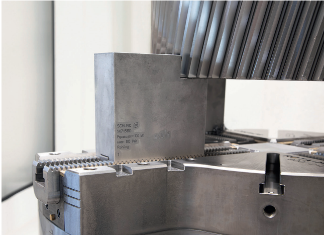
6 Unter Verwendung passender Aufsatzbacken lassen sich viele Teile mit unterschiedlicher Geometrie spannen © Schunk
