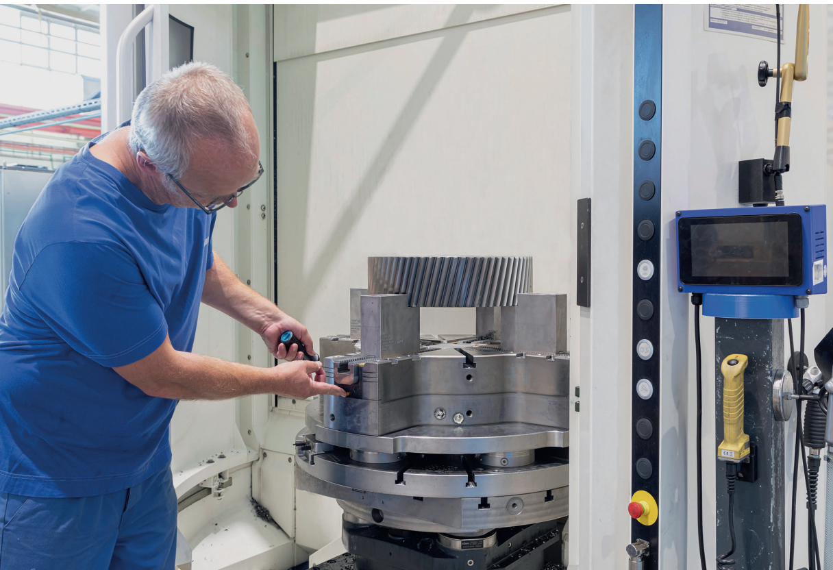
1 Bediener-sicherheit über den Anzeigestift in den Spannbacken des Drehfutters 'Rota-M flex 2+2' von Schunk: Wäre nur ein Backenpaar auf Futterend-lage gespannt, aber nicht das komplette Werkstück, würde dies der Stift an der Backe optisch anzeigen © Schunk
